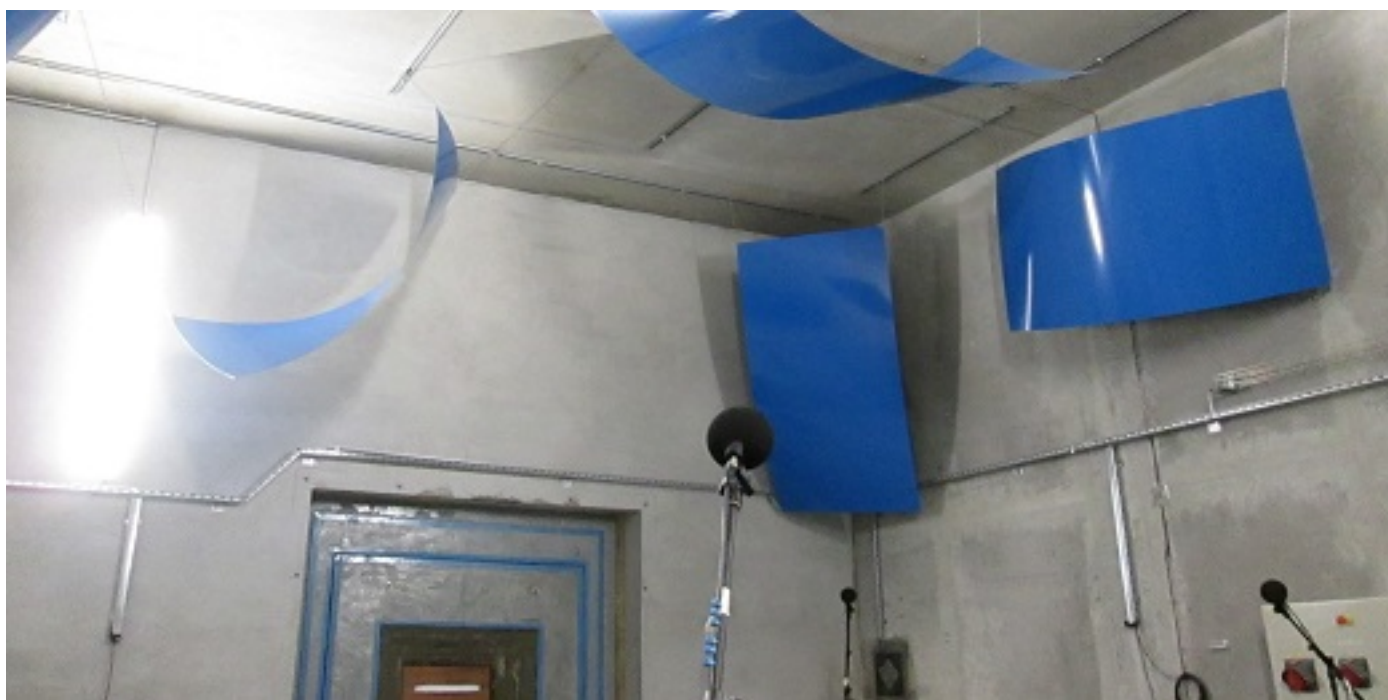
Mesures acoustiques dans l'une des chambres réverbérantes au CETIAT
