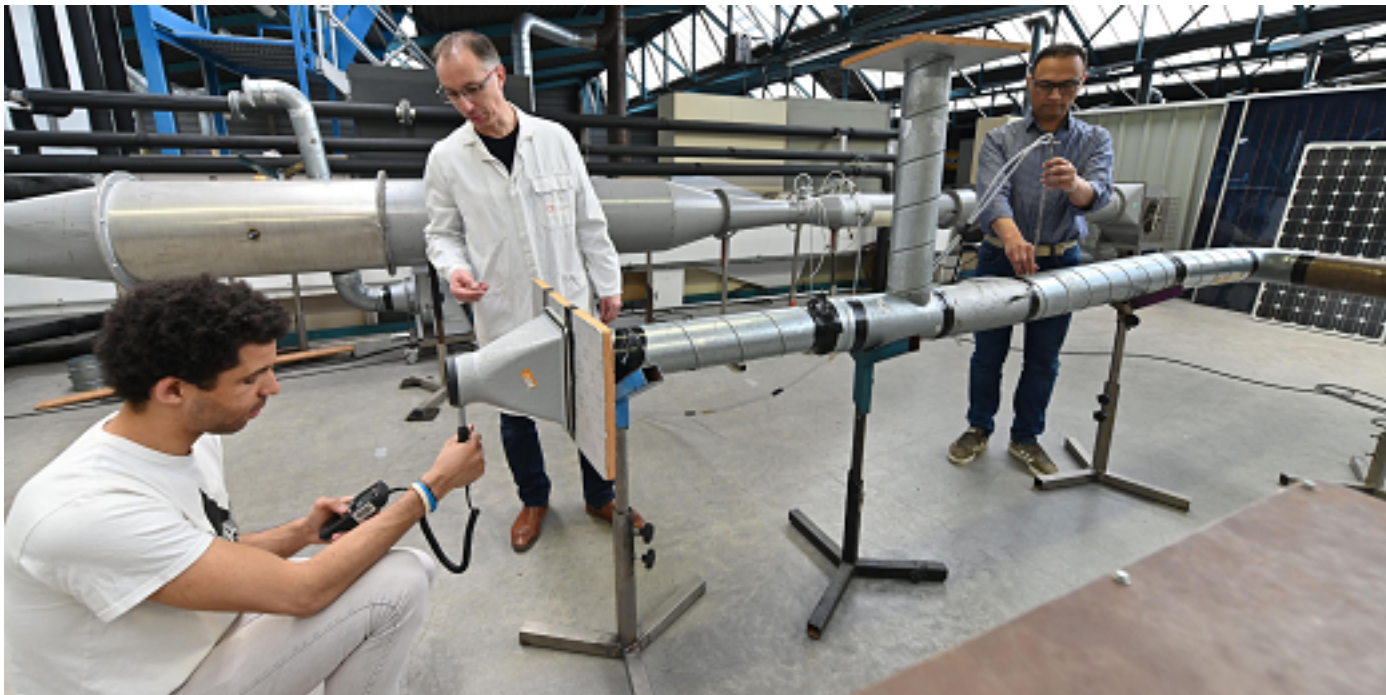
Travaux pratiques sur la plate-forme pédagogique ventilation du CETIAT
